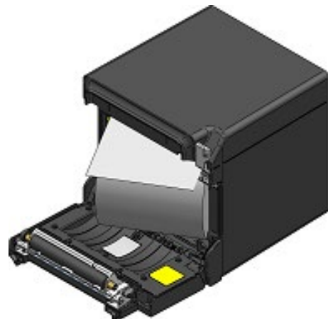
Рисунок 8-6 Состояние установки термобумаги (вывод вперед)
