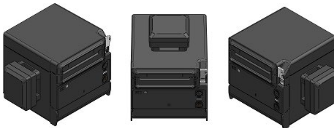
Рисунок 13-5 Пример места установки внешнего зуммера (вывод: вперед)
