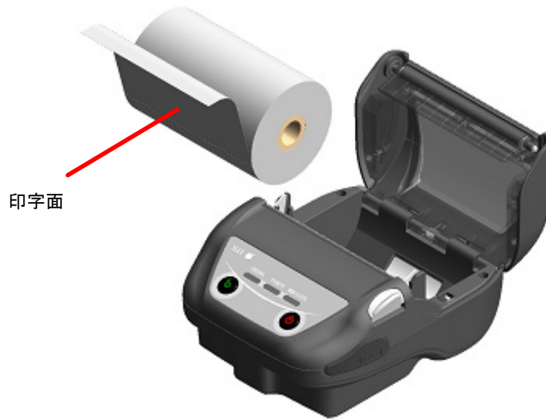
図 9-2 感熱紙セット方向
