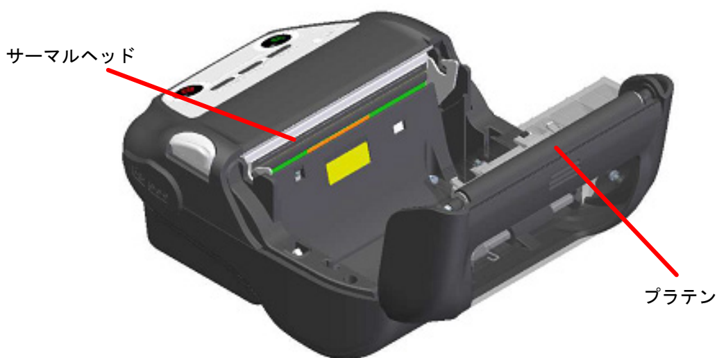
図 20-1 サーマルヘッド／プラテンのクリーニング
