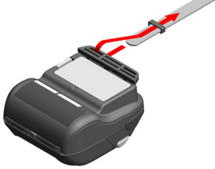
Şekil 13-7 Omuz Kayışının Takılması (3)
