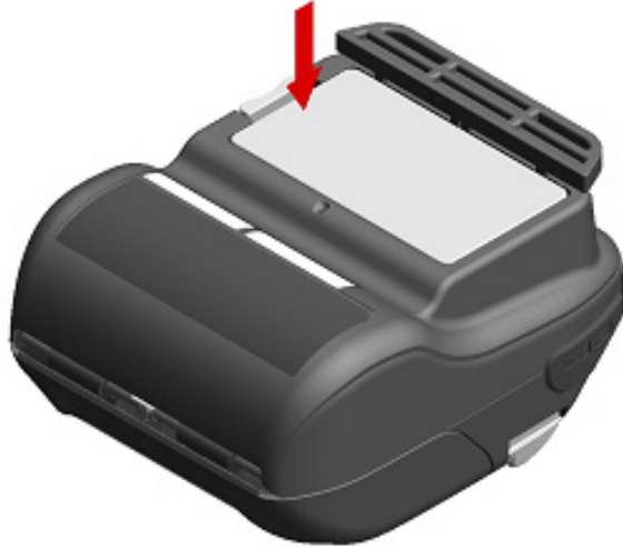
Şekil 13-6 Omuz Kayışının Takılması (2)
