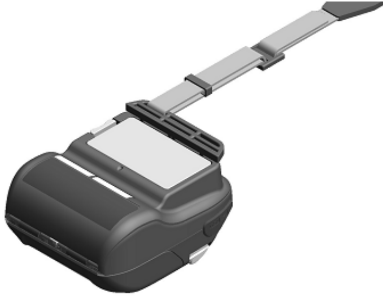
Şekil 13-8 Omuz Kayışının Takılması (4)
