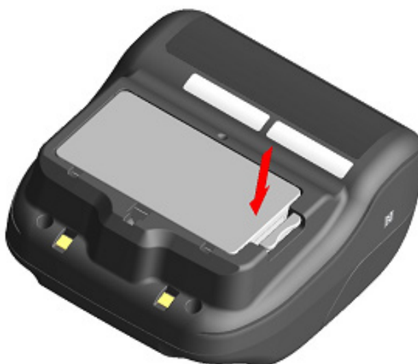
Figura 8-3 Installazione della batteria (2)
