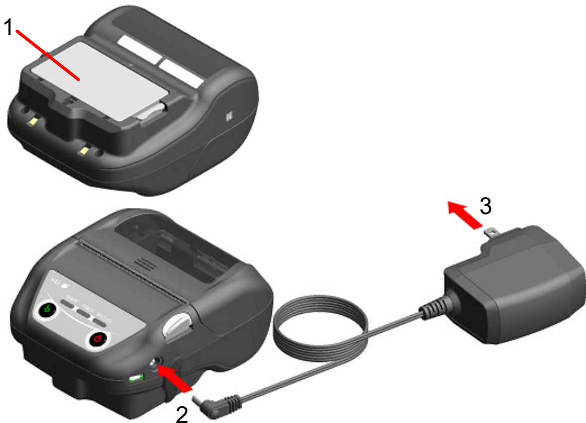
Illustration 14-2 Chargement en mode de chargement hors tension avec l'adaptateur c.a.
