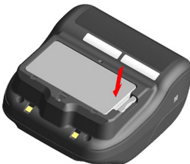
Illustration 8-3 Installation de la batterie (2)
