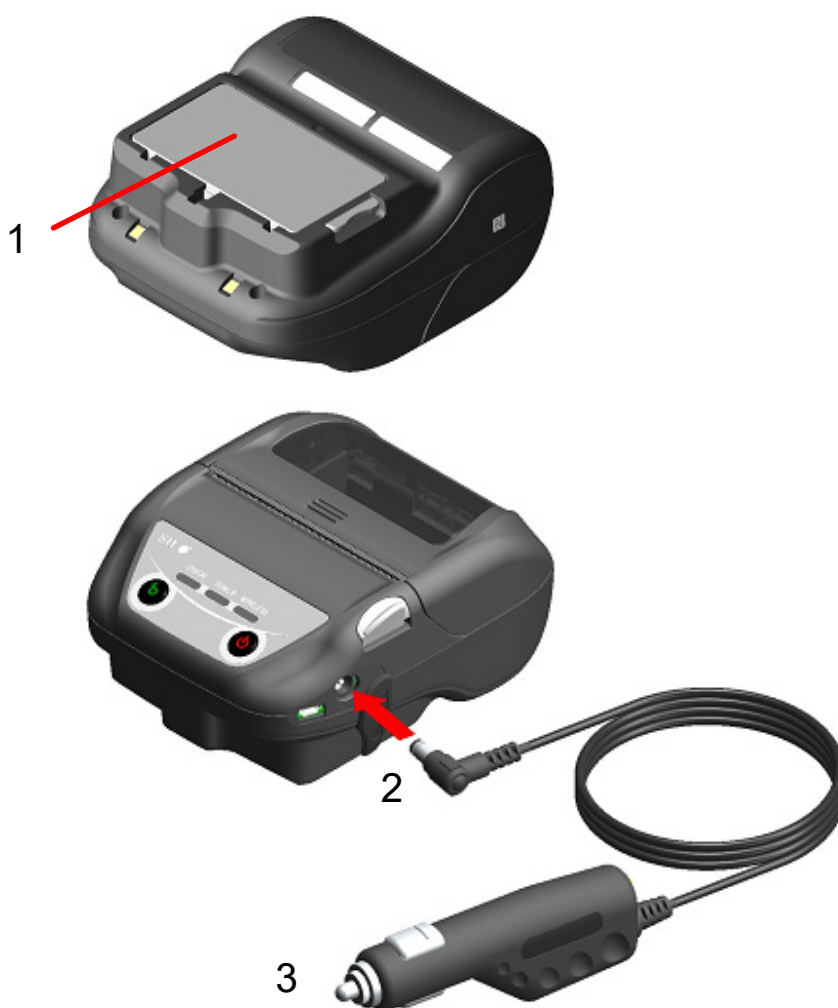
Illustration 16-3 Chargement en mode de chargement hors tension avec le chargeur de voiture
