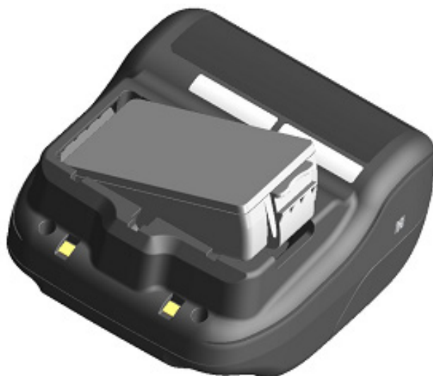
Figura 8-2 Instalación de la batería (1)
