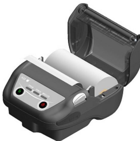
Figura 9-3 Estado de colocación del papel térmico
