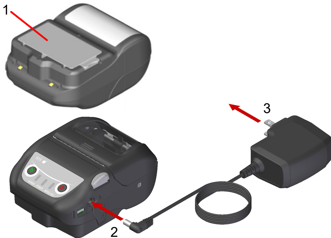
図 16-2 ACアダプタによるパワーオフ充電モードでの充電
