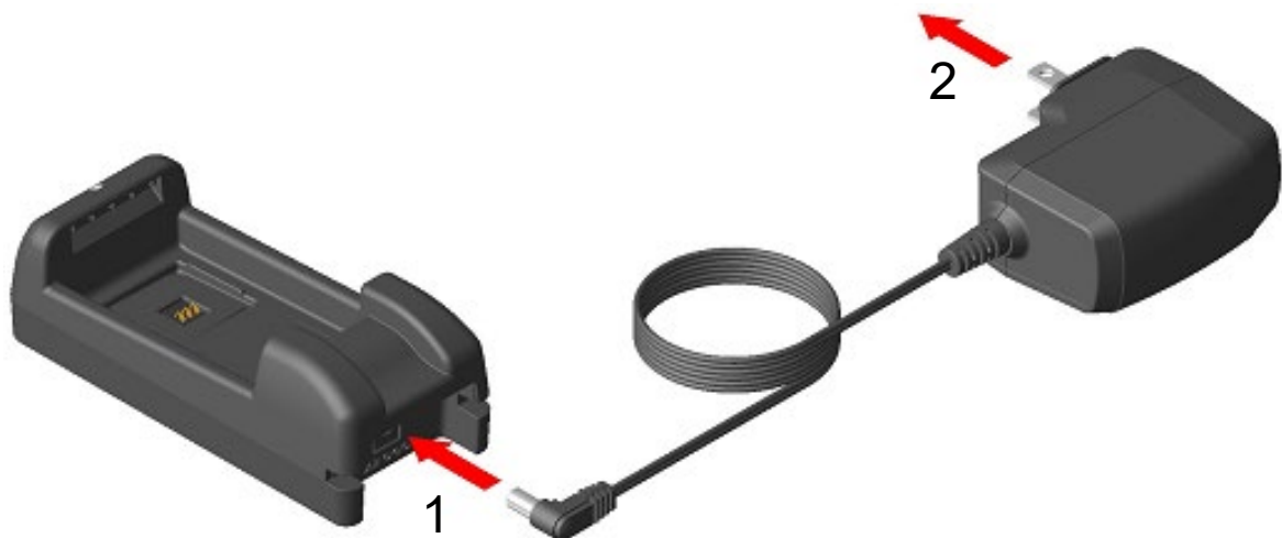
図 19-2 充電器とACアダプタの接続
