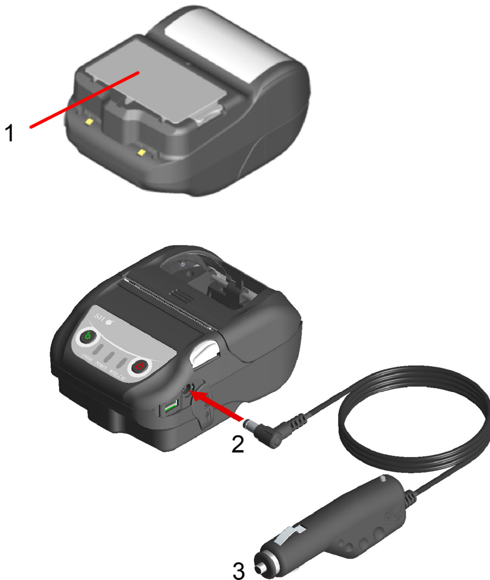
図 18-3 カーチャージャによるパワーオフ充電モードでの充電
