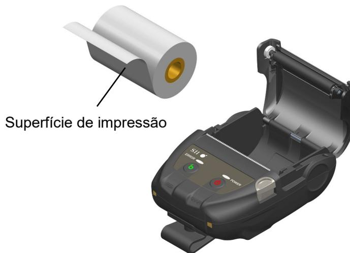
**Figura 9-2 Direção da definição do papel térmico**
