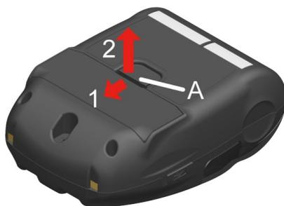
Figura 15-1 Remover a bateria (1)
