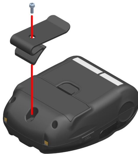
13. ábra -1 Az övcsat csatlakoztatása/leválasztása
