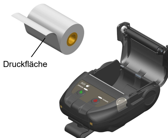
Abbildung 9-2 Ausrichtung des Thermopapiers beim Einsetzen
